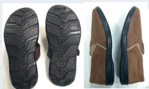
चित्र 2. इंजेक्शन मोल्डेड पीयू-नैनोफिलर कम्पोजिट सोल का उपयोग करके निर्मित पूर्ण फुटवियर
